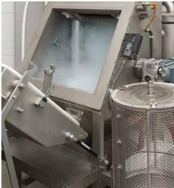
Strahl-Anlage mit Stickstoffkühlung
