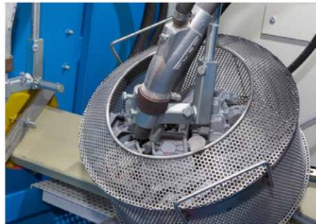
Druckstrahlen mittels Granulat
